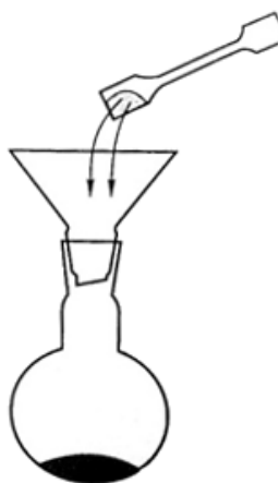
Рис. 6. Загрузка сыпучих веществ в колбу
