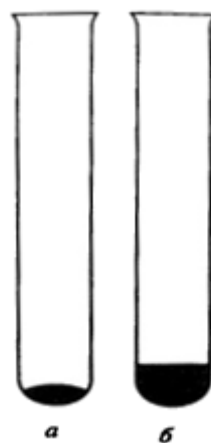
Рис. 7. Рекомендуемые количества реагентов для проведения качественных опытов: а — твердое вещество; б — раствор
