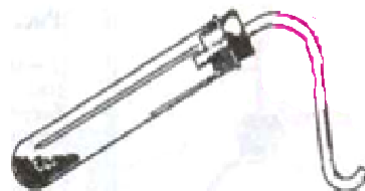
Рис. 13. Простейший прибор для получения газа
